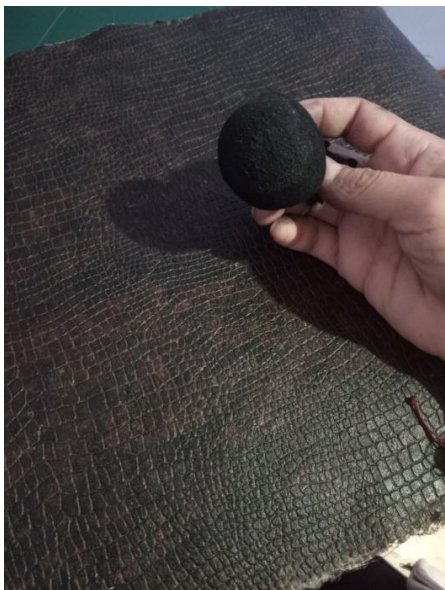
Figura 6. Sustituto de cuero a base de cabuya negra
