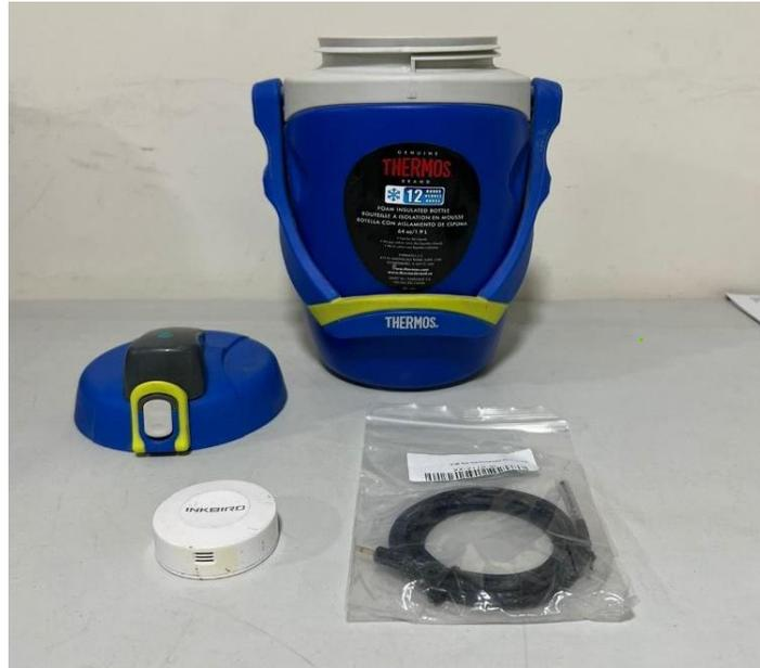
Figura 5. Instrumento para mediciones térmicas durante la hidratación temprana de mezclas hidráulicas cementosas (ASTM C1753-15)
