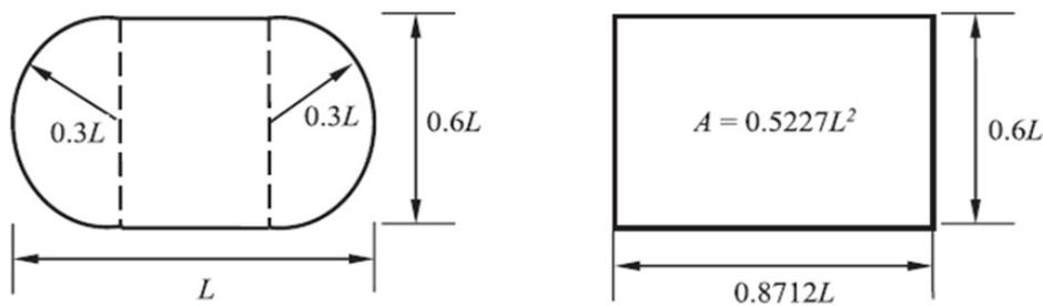
Figure 6. Tire contact area<sup>(3)</sup>
